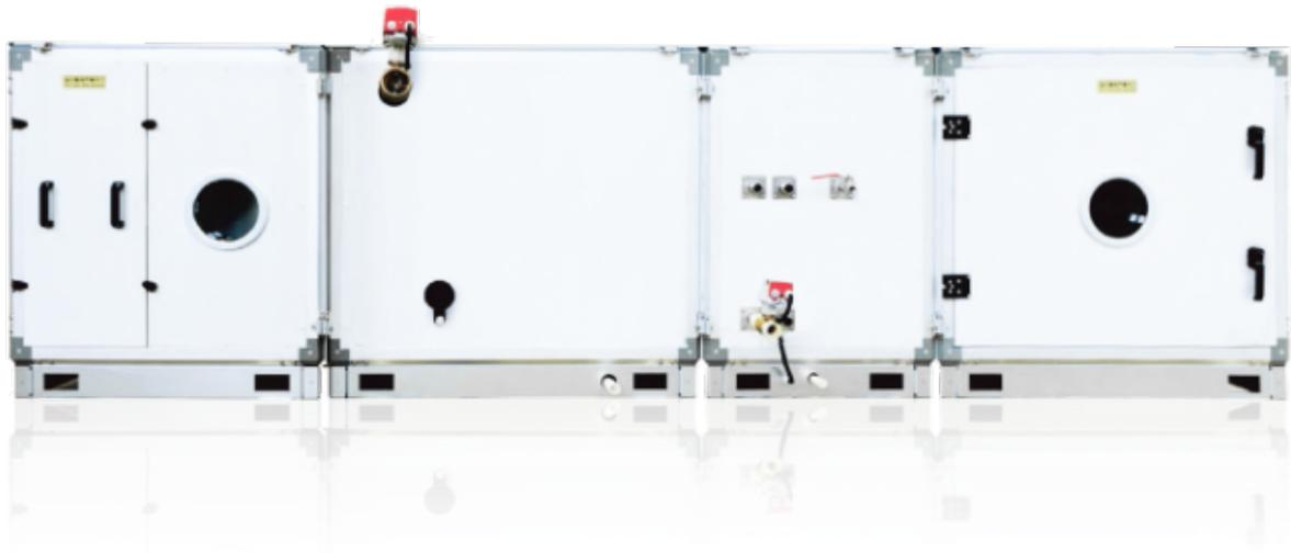
当新风机运行时，根据送风温度和温度设定值进行PID运算，控制水阀的开度，从而调节送风温度达到温度设定值，当新风机组停止时，水阀关闭（制热模式下，会留小开度，这里先省略不说了）。新风机组运行时，阀门根据温度调节开度，停止时，阀门关闭为0%。分为2个模式控制，夏季制冷模式，送风温度相比温度设定，送风温度越高，水阀开的越大，相反温度越低，水阀开的越小。冬季制热模式，送风温度越高，水阀开度越小，温度越低，水阀开得越大。防冻报警时，水阀开度100%。夏季制冷模式，注意正比例引脚，正比例为“真”，什么意思？白话解释，送风温度越大，输出开度越大。让盘管过更多得冷水，风经过盘管就会降更多得温度。江苏商用新风机组工作原理通常新风机组的大风量是按满足卫生要求而设计的。
